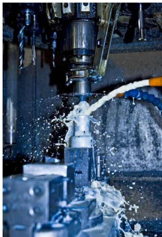
На нашем производстве. Вверху показана обработка цилиндра пневматического насоса 5:1 на обрабатывающем центре.
